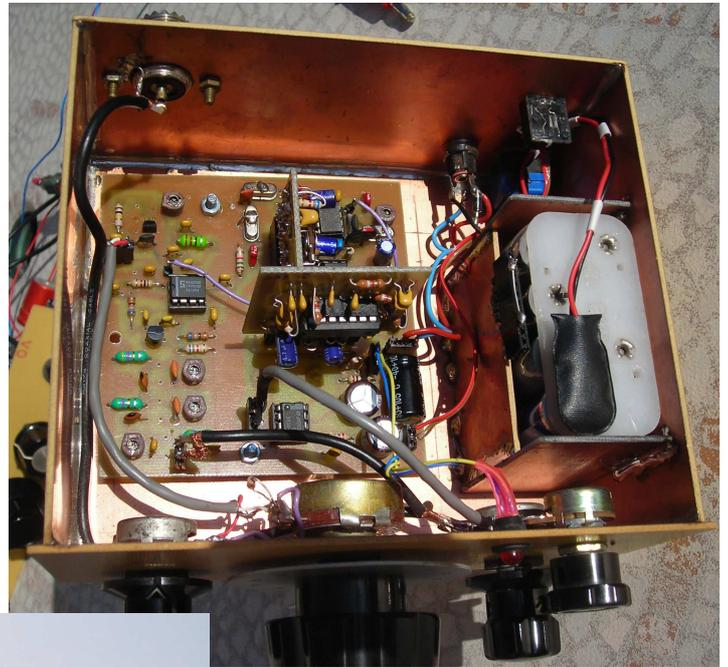
MARMOTTON en boîte faite avec du circuit imprimé
