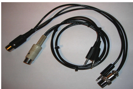
Les deux cordons à faire : fiche DIN noire pour le TRX Fiche DIN grise pour le PC ( attention à la masse pour celle-ci, elle ne doit pas être reliée à la tresse des fils). Il faudra aussi un cordon RS232 mais il est préférable de l'acheter.
