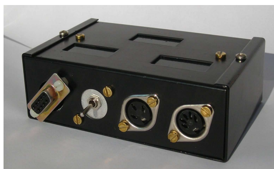
Face arrière avec les connecteurs . On notera la prise RS232 isolée du boîtier
